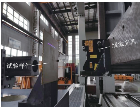
图 8 激光刻型在机精度检测试验平台
